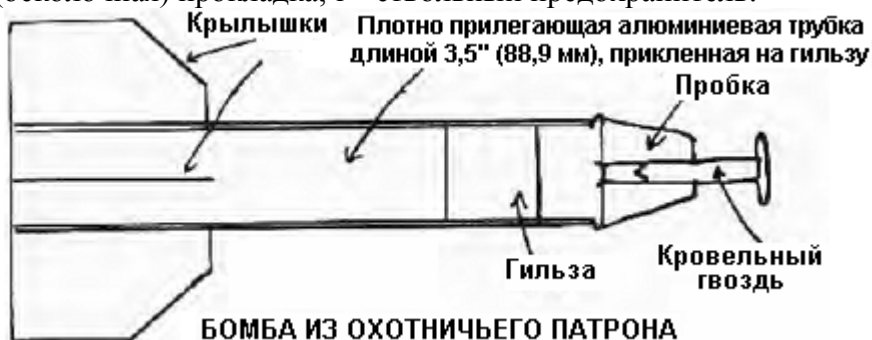
Рис. 9 – Инерционный взрыватель (см.: «Оружейник бедного человека», Том 1 – С. 21). Примечание: В статье рисунок отсутствует, этот взят из книги «Джеймс Бонд бедного человека», Том 1.
